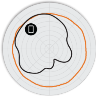
РИСУНОК 2 Азимутальная плоскость 2,4 ГГц H510 Диаграммы направленности антенны
