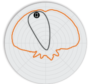
РИСУНОК 5 Вертикальная плоскость 5 ГГц H510 Диаграммы направленности антенны
