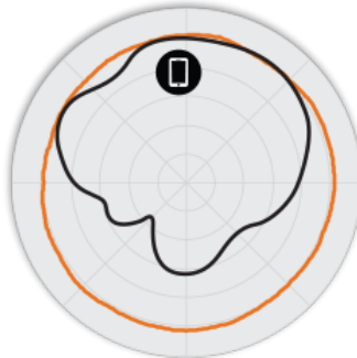
РИСУНОК 3 Азимутальная плоскость 5 ГГц H510 Диаграммы направленности антенны
