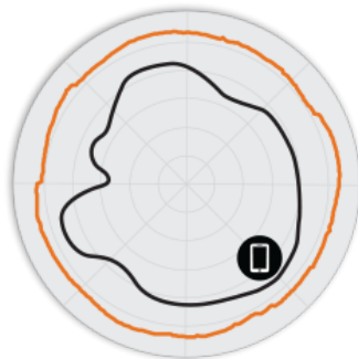
РИСУНОК 3 Азимутальная плоскость 5 ГГц R750 Диаграммы направленности антенны
