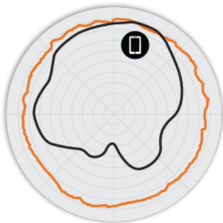
РИСУНОК 2 Азимутальная плоскость 2,4 ГГц R750 Диаграммы направленности антенны
