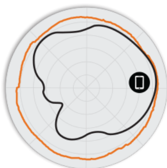
РИСУНОК 3 Азимутальная плоскость 5 ГГц T610o Диаграммы направленности антенны
