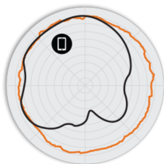
РИСУНОК 2 Азимутальная плоскость 2,4 ГГц T610o Диаграммы направленности антенны
